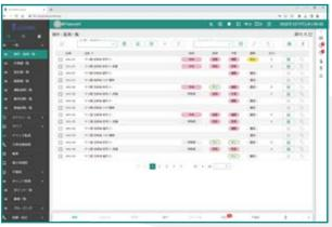
機器のON/OFFや故障状態、温湿度の計測等を一覧表示します。 また、機器の操作や計測値のトレンドグラフ表示も行えます。
