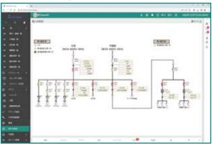
平面図や系統図等の詳細なグラフィックを表示します。 よく見るデータをダッシュボード画面に配置する事も可能です。
